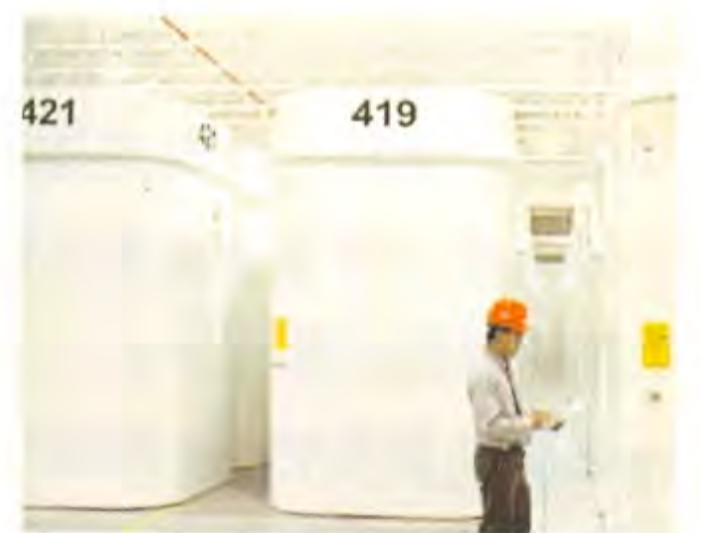
圖6.廠內的乾式貯存容器標號、封緘後，未來將移入新設施中
