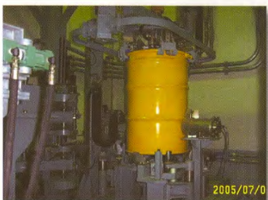
圖3.劑量量測及表面擦拭站
