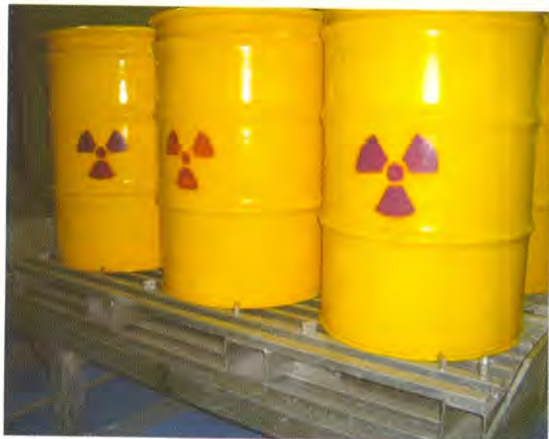
圖1.台灣獨有的設計--棧板上突出的小鐵片，可使貯存桶在地震中不易傾倒
