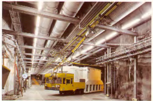
圖2. 以電動車輛將運送放射性廢棄物的容器，從地面送到地下的岩穴內
