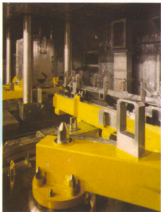
圖3.洛普再處理廠的剪力封裝機
