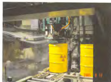
圖2.處理中心：針對廢棄物桶，分別設置檢整或重裝作業線。圖為處理中心的固化灌漿作業區
