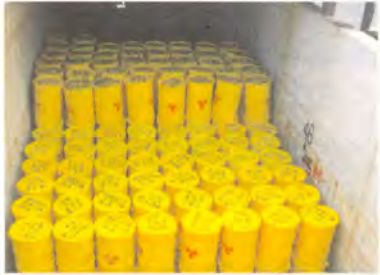
圖5.貯存溝內廢棄物桶回貯狀況
