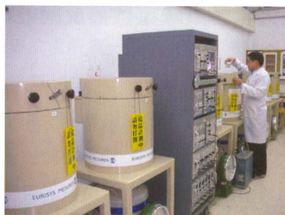
圖 2 放射性含量分析作業（加馬能譜分析）
