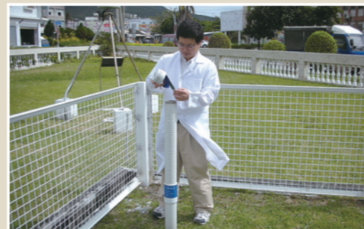
▲ 圖1 採取核能電廠周圍環境試樣的作業情形
