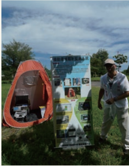
▲ 左：機動式環境監測系統，內有蓋革計數器；右：迷你型氣象儀
