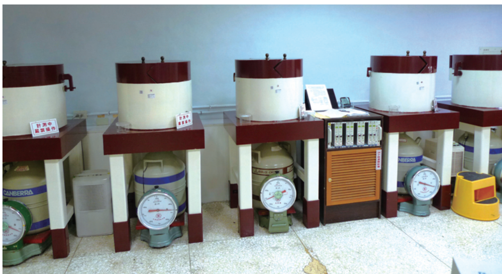
▲ 利用加馬能譜分析系統可檢測出樣本中的放射性物質
