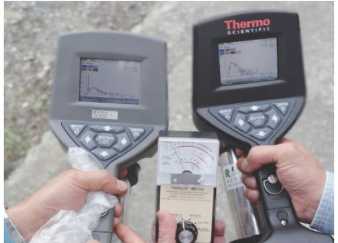
▲左：與日方同型的儀器，受影響即產生錯誤數值；右：新款儀器，有電子磁場防護顯示正常；中：度量電磁場的高斯計
