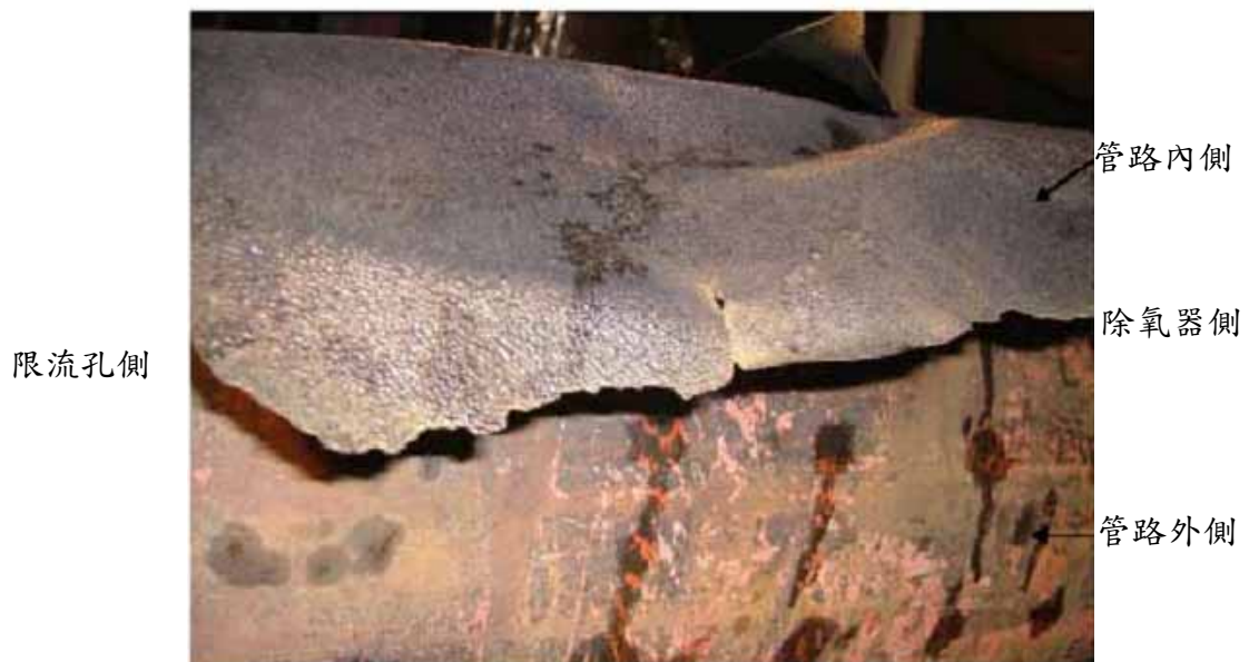
圖 6 美濱之管路破斷處放大照片
