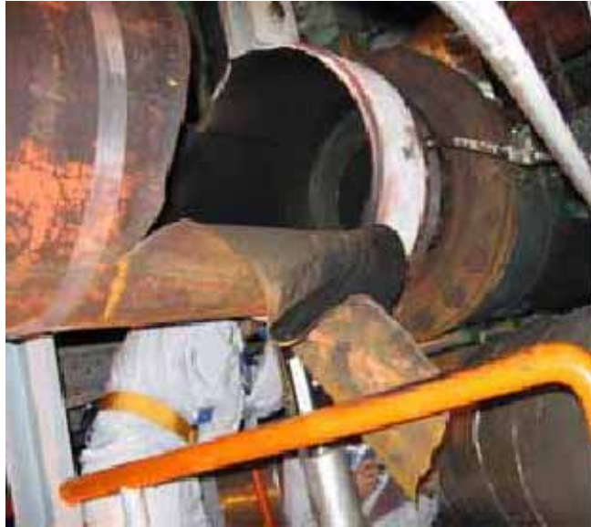
圖 1 美濱 3 號機管路破斷處（右側為上游，左側為下游）
