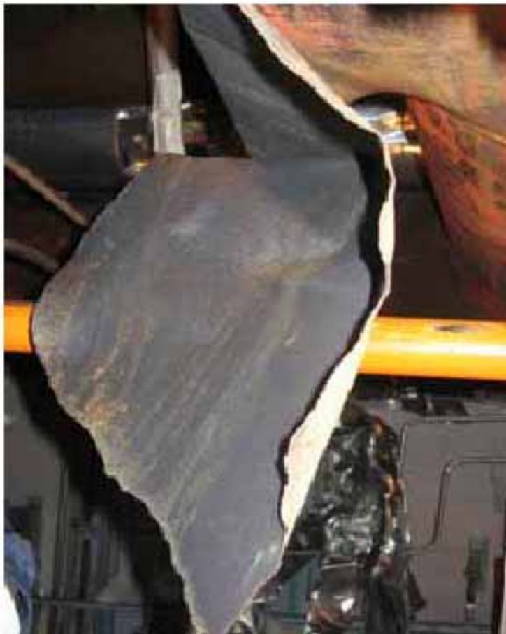
圖 2 薄化至 0.6mm 破斷的管路
