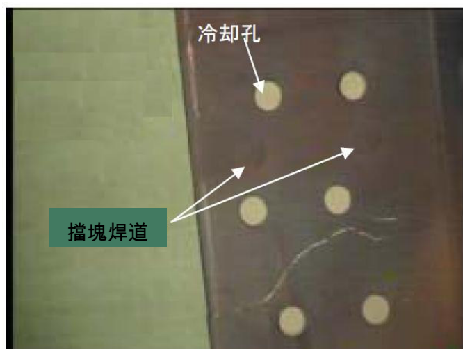
圖 1 鉛板型控制棒之裂紋
