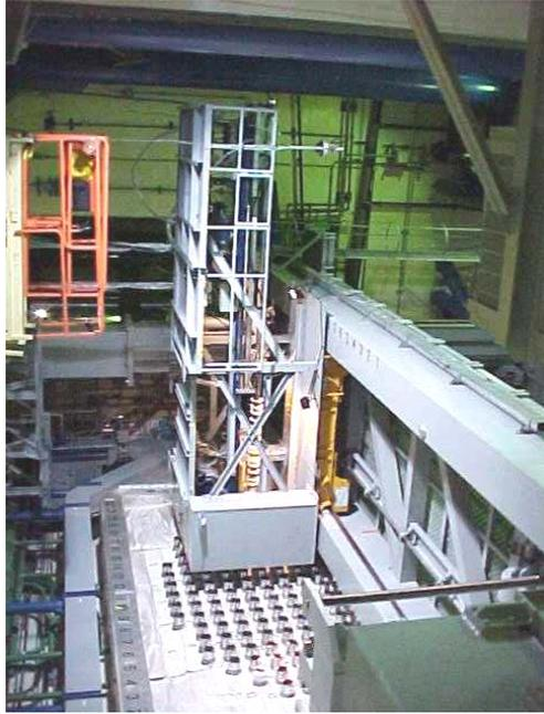
照片 2 運轉中可更換燃料的 CANDU 型燃料更換設備
