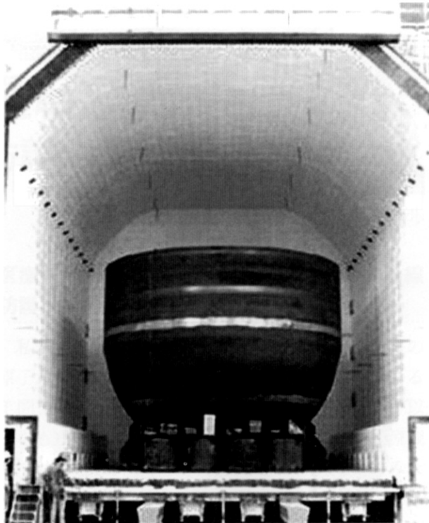
照片 3 Atucha 2 號機反應爐容器
