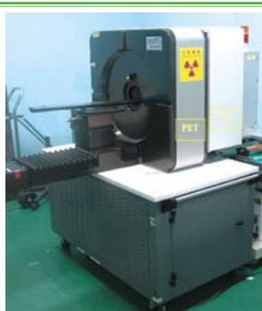
圖一：核研所micro-PET/CT雙功能造影系統
