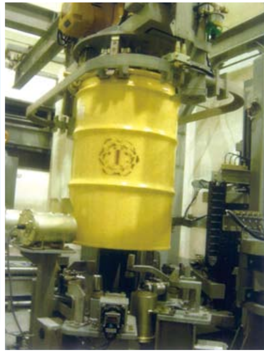
低放射性廢棄物模擬桶之偵檢作業圖片
