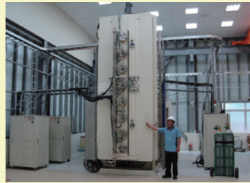
圖三、大型螺桿電漿披覆系統（φ 1,500' L4,500mm）
