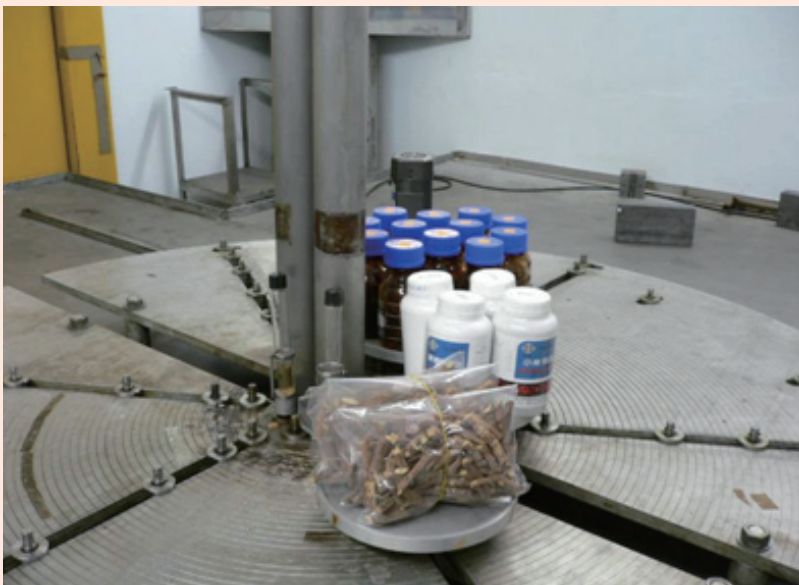
圖一、科學中藥及甘草樣品於鈷六十照射熱室之照射轉盤上進行照射中，中央之2支管柱內有鈷六十放射源。
