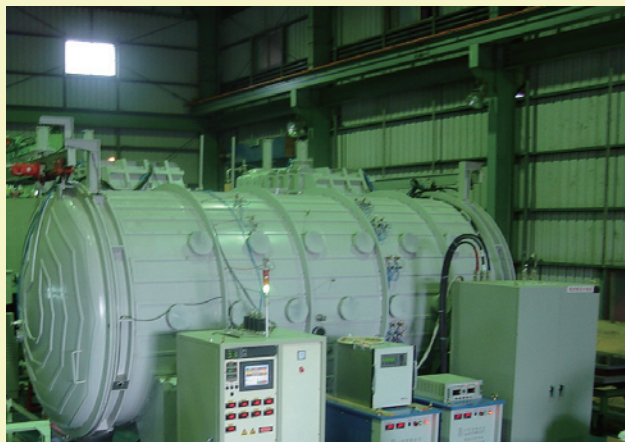
圖一、大型臥式建材裝飾鈦鍍膜被覆系統（φ 2,400' L5,000mm）
