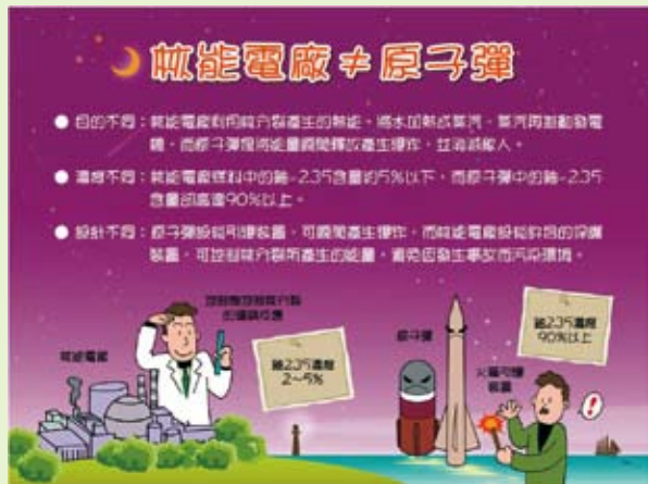
圖三 核能發電和原子彈在目的、工作原理、使用的鈾235濃度和設計上的差異比較。
